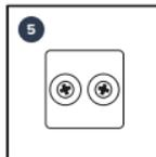
5 Vissez jusqu'à ce que le support soit solidement fixé et que les vis affleurent leurs rainures
