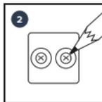
Markieren Sie mithilfe der Halterung die zwei Bohrlöcher
